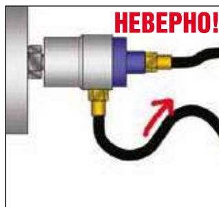
Участок шланга направлен вверх
