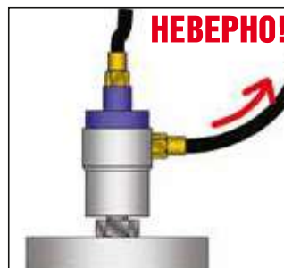
Отводной шланг направлен вверх
